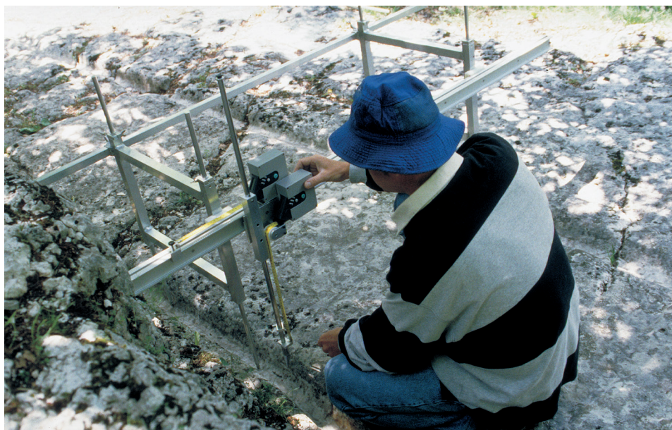
Mit einem eigens dafür entwickelten Spezialmessgerät wurden die Spurweiten der Geleisestraszen ermittelt.
